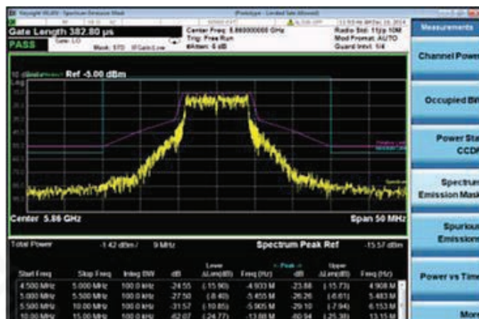
使用 Keysight N9077 WLAN 测量应用软件对基于 802.11p 标准的发射机进行 SEM 测量，该发射机的最大输出功率为 0 dBm，发射频率为 10 MHz，通过 FCC A 类认证。
