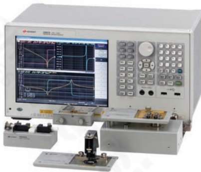
采用 E5061B ENA 系列网络分析仪进行网络和阻抗组合分析
