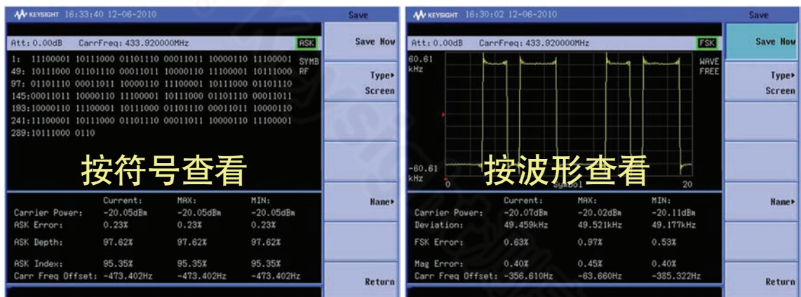
N9320B/N9322C 频谱分析仪提供一键式 FSK 信号分析以及符号和波形视图
