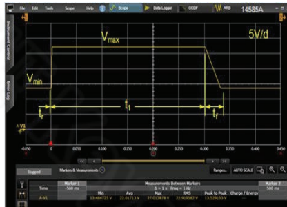
LV 124 / VW 80000 2013-06: 采用 APS 测试 E-05 发电机负载变化
