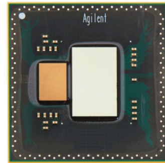
65 nm CMOS 工艺ADC (以及130 nm Bi-CMOS 缓冲IC)
