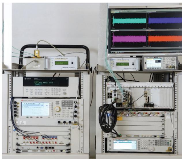
图 4 信道测量系统实物照片
