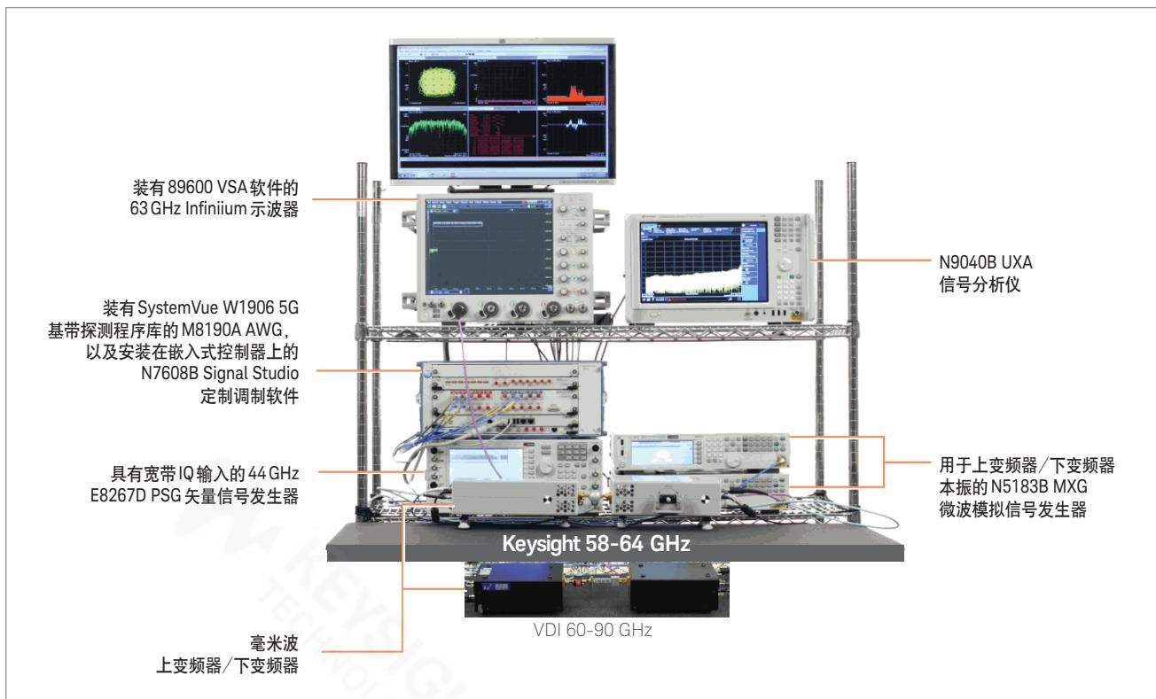
图10. 仪器与硬件完美结合, 可以为探索可能实现的5G技术提供极大的灵活性。
