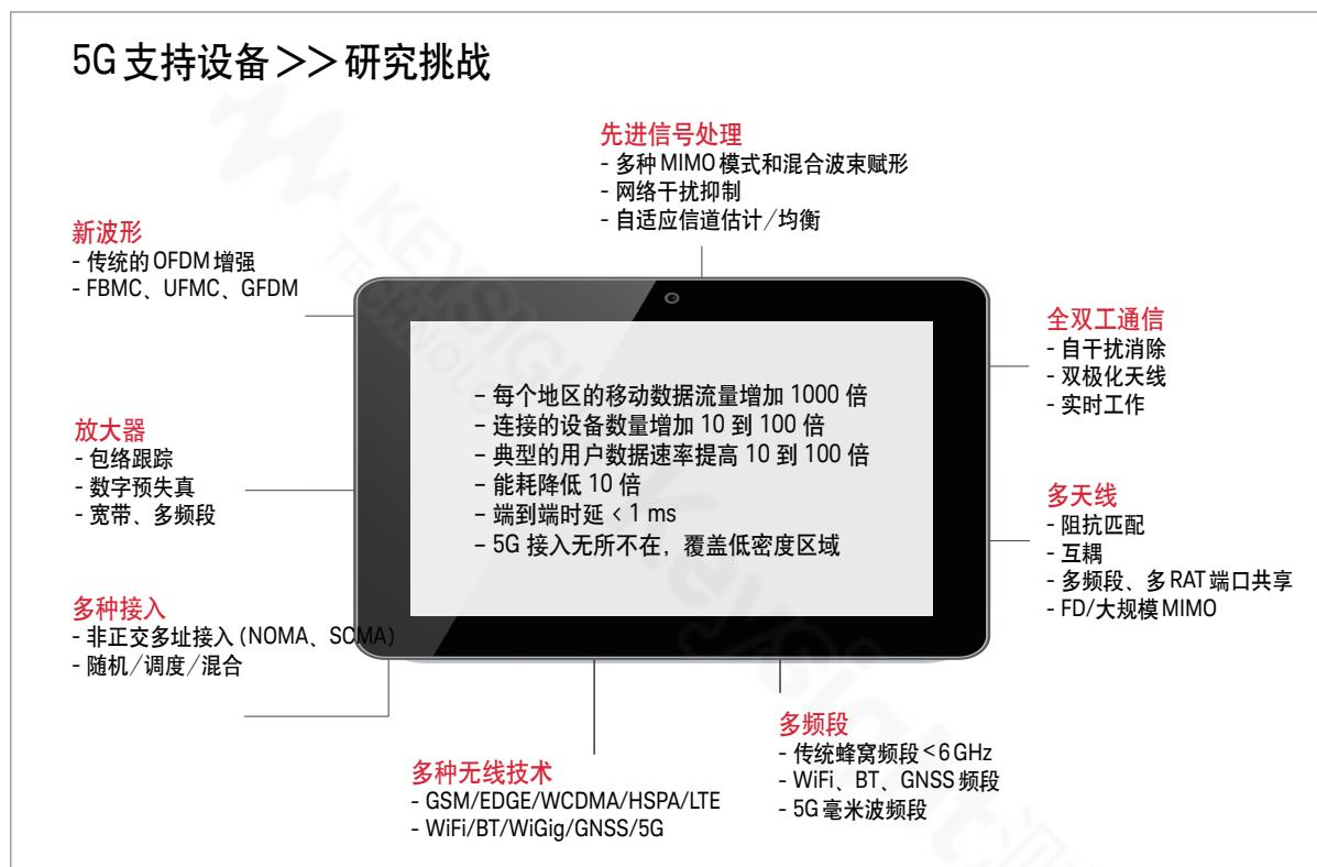
图1. 研究人员需要采用多种不同的支持技术、设备和方法来实现目前预想的六种5G技术特性<sup>2</sup>。
