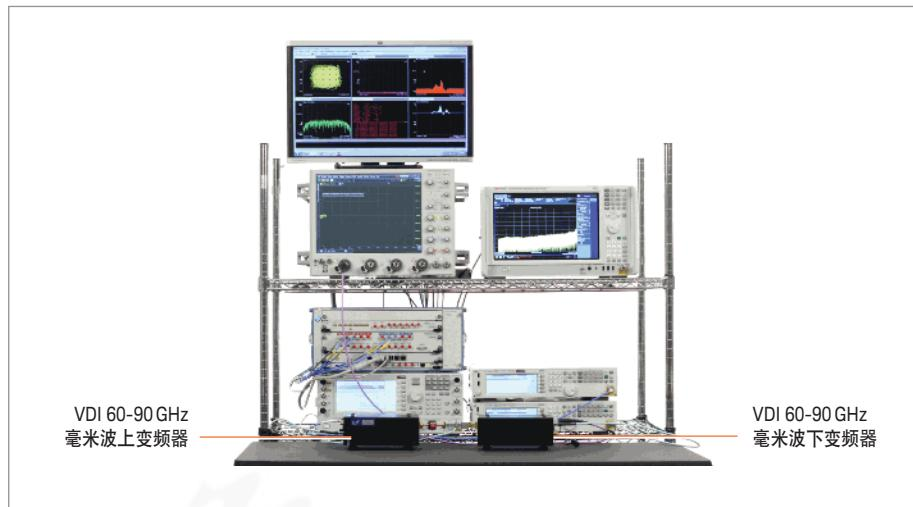
图21. 改变上变频器并添加下变频器可以实现在 72 GHz 上的工作。
