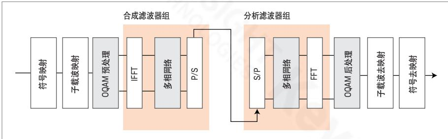
图 4. FBMC 中的滤波器组可以对每个子载波进行滤波。
