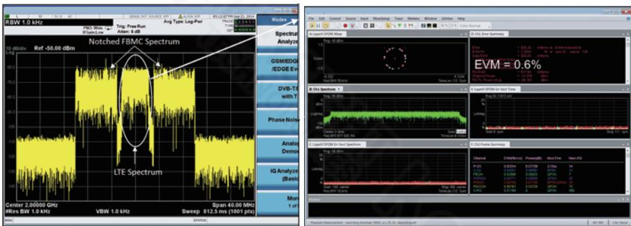
图13. LTE信号位于凹陷的FBMC频谱的中心。
