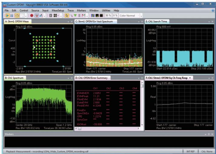
图17. 89600 VSA软件屏幕快照显示了解调OFDM信号的多个视图。
