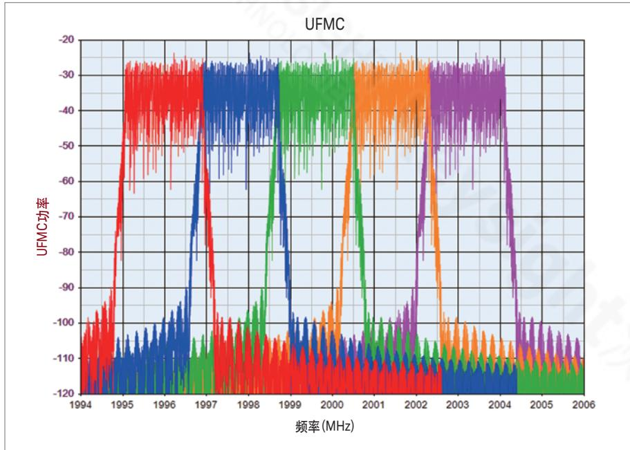
图 7. UFMC 波形(由 SystemVue 生成)仿真显示了 5 个复用频段。
