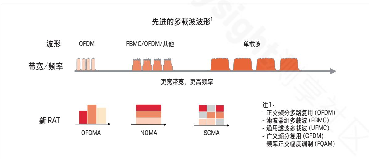
图 2. 5G 候选波形覆盖多种可能实施的方法。
