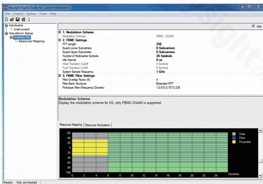
图15. Signal Studio定制调制软件GUI使用户可以非常方便地输入全套FBMC参数。
