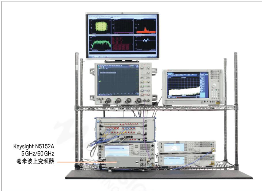
图18. 此版本的推荐测试台能够生成毫米波信号。
