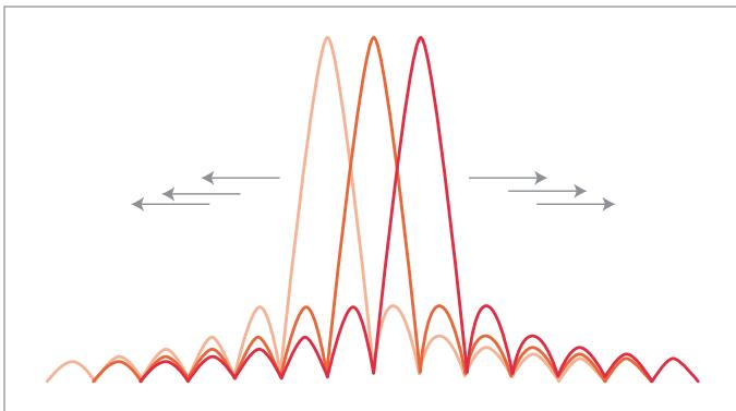
图 3. OFDM 提供频谱效率、抗多径干扰性和零载波间干扰等优势。
