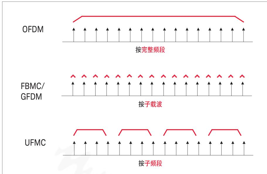
图 6. OFDM、FBMC 和 UFMC 使用的滤波方法差别很大。
