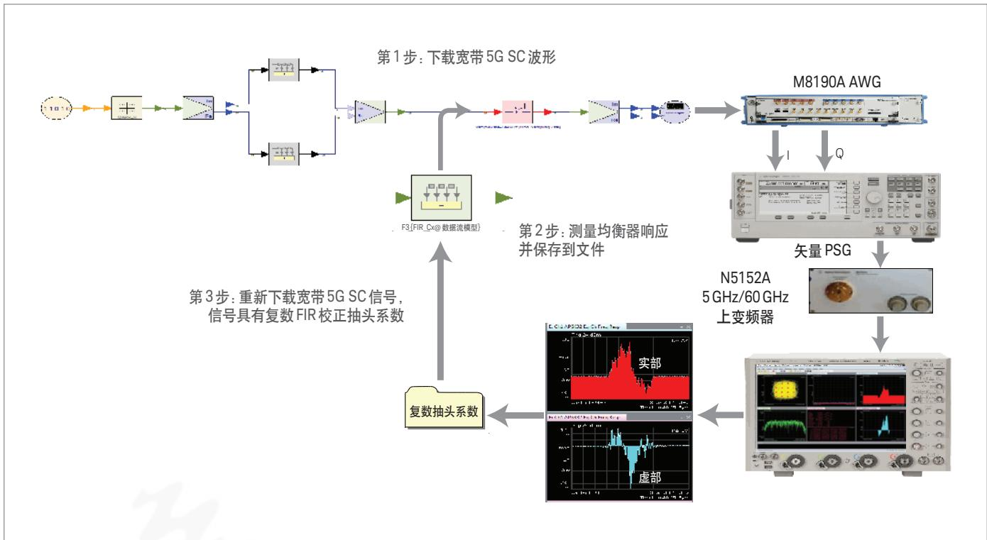
图19. 自适应均衡器产生的频率响应可以补偿测试信号中的线性幅度和相位误差。
