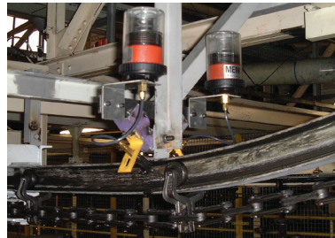
汽车工业: 空中传输带辊和轨道润滑。
